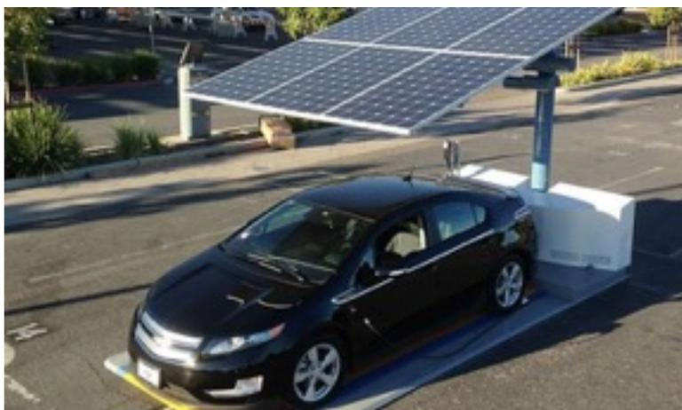
В проекте используются солнечные панели с КПД, близким к 20%. Такая высокая эффективность достигается за счёт применения системы слежения за Солнцем. Панели поворачиваются к нему для достижения наиболее выгодного угла падения лучей. Станция может вырабатывать около 3,3 кВт энергии и хранить 22,5 кВт\*ч в Li-Ion аккумуляторах. Стоимость каждой станции будет составлять \$45 тыс. Пользование автозаправками будет бесплатным.
